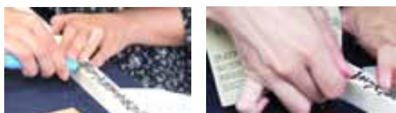
図5 カッターで削り（左）、サンドペーパーで整えている（右）様子
